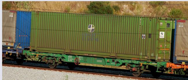
Foto inferior. Elementos 3º y 4º de la plataforma Laagooss 43 87 437 4 000-5 SNCF de Transfesa (Foto: catálogo Transfesa)
