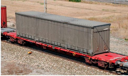
Plataforma TAKARGO, Sgnss en servicio para el tren "Papelero" (Foto: Javier López Ortega -www.spanishrailfreight.com-)
