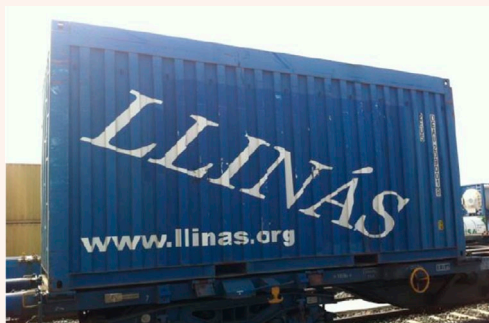
Contenedor de 20 pies abierto para transporte de chatarra (Foto: MFTrain)
