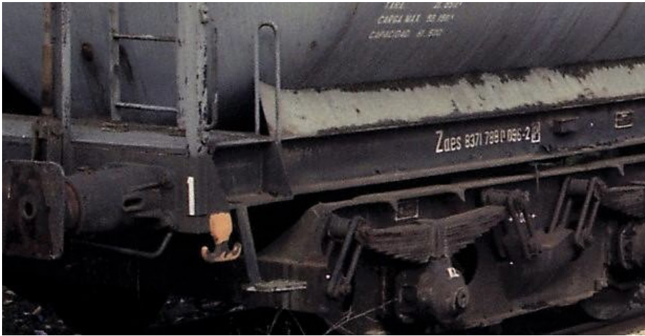
Imagen izq. Detalle del bastidor de una cisterna tipo de "Zaes" construida por Herederos de Ramón Múgica (detalle foto: Jesús M.Pérez de Val)
