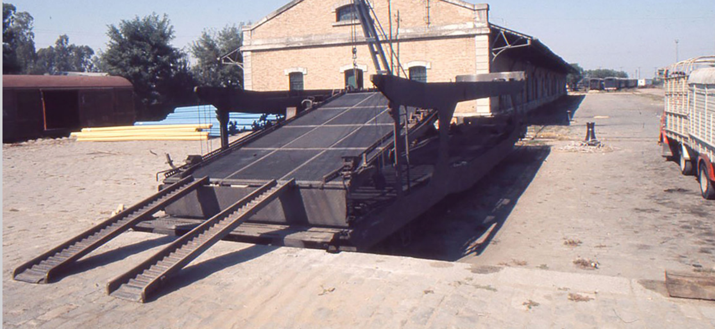
Sistema de carga en plataformas con piso superior inclinable, como la PMA-26.000 de la fotografía (Foto: autor desconocido)
