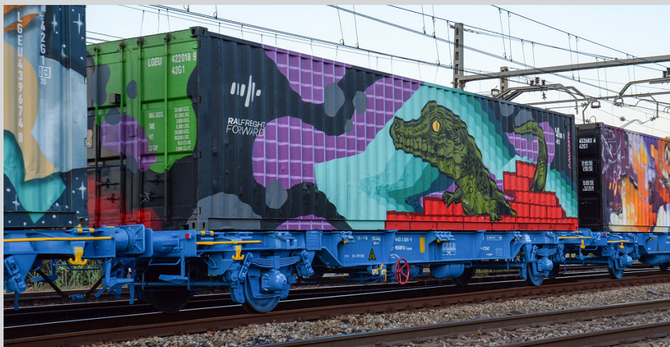
Foto Izq. Plataforma Lgnss, una de las 8 tipo MC3 utilizadas en el tren de Noé. La protagonista de este fotografía es la MCc-471.347, UIC Lgnss 22 71 4433 346-4 E-RENFM (Septiembre 2019. Foto: Javier López Ortega)
