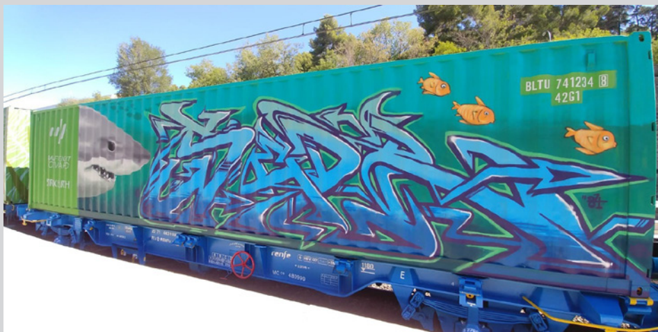
Foto Izq. Una de las dos plataformas Lgnss de 40 pies tipo MCI utilizadas en el Tren de Noé, en concreto la MCc-480.999, UIC Lgnss 22 71 4439 999-4 E-RENFM (Madrid-Príncipe Pío, Septiembre 2019. Foto: Emiliano Carro Bravo)
