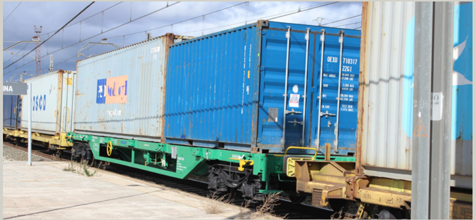
Foto drch. Plataforma "Sgs" 83 71 454 5 014-9 E-TRFSA con carga de contenedores de 20 y 40 pies (La Encina, Noviembre 2019. Foto: MFTrain)
