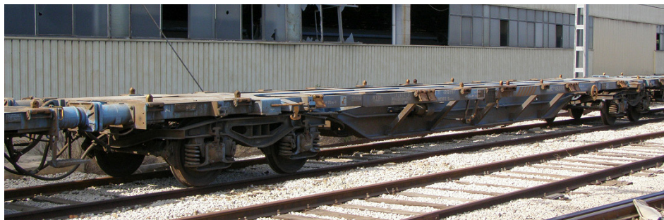
Plataforma MMC3e / Sgnss de RENFE con franjas amarillas y logotipo de Transporte Combinado (Agosto 2008. Foto: Javier López Ortega)
