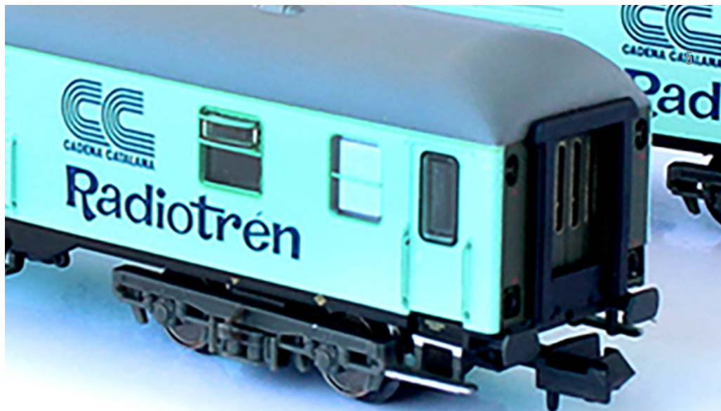
Detalle del bogie Minden-Deutz de Renfe con Statodyne.
