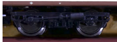
Detalle del bogie Minden-Deutz de Renfe con Statodyne.
