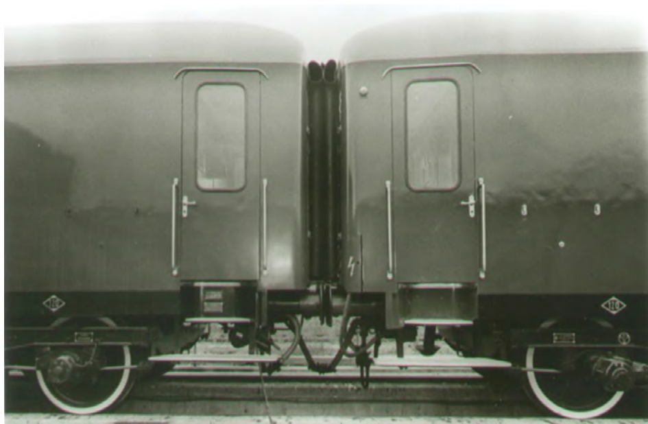
Acoplamiento entre dos furgones de la serie 8.100 recién construidos (1973, Foto: CAF)
