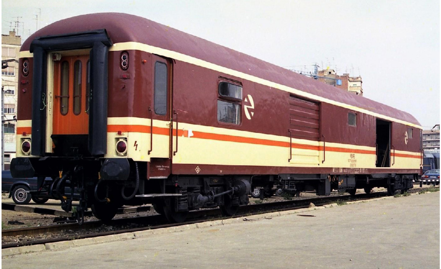
Furgón D8-8.176 (perteneciente a los fabricados por Vers) con bogies Schindler y decoración "Estrella" (Valencia-Término, Septiembre-1989, Foto: Jesús M. Pérez de Val)
