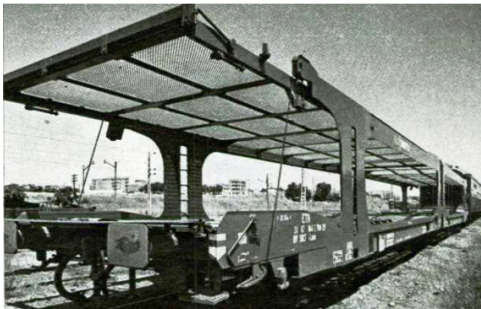
Foto derecha: Plataforma porta-automóviles "Laeks" TA 373 de Transfesa, recién construida (Foto: Transfesa)
