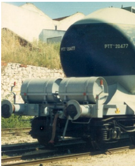
Foto superior: Detalle de los calderines de freno de vacío en la foto de Paulo Ferreira
