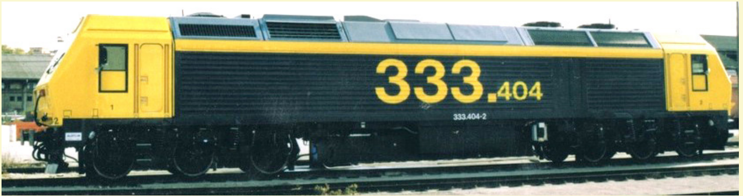
Locomotora diésel 333 - 404 - 2 recién salida de la factoría de Vossloh en colores de la UN de Tracción. Fotos: Costa Martínez
