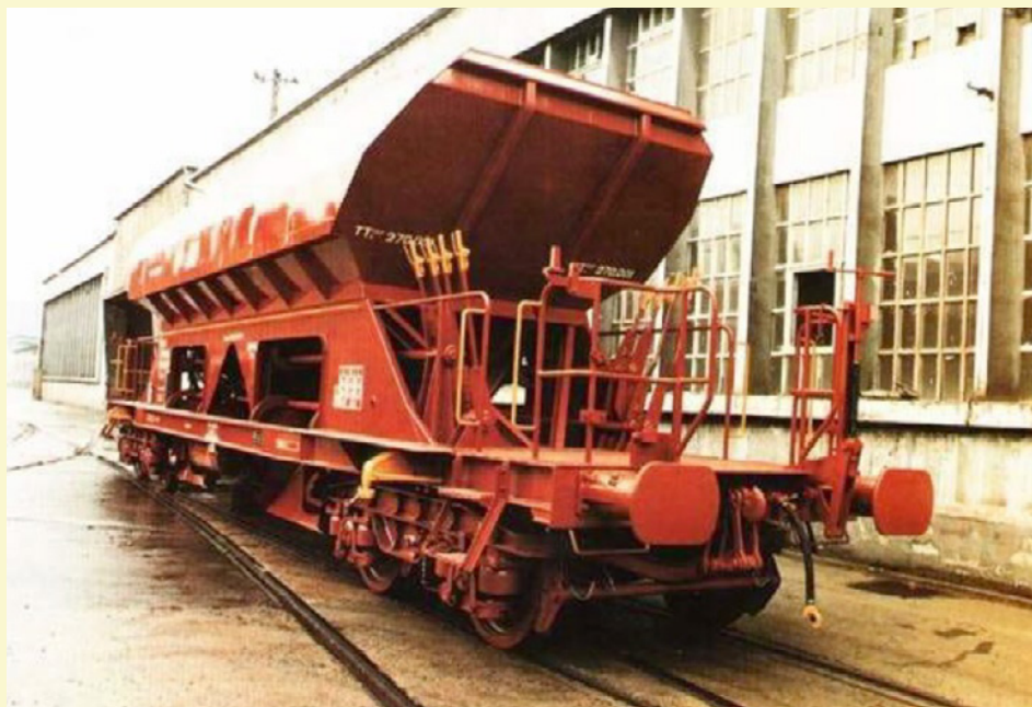
Foto superior. Tolva prototipo TTchp-270.001 recién fabricada (Foto: CAF)
