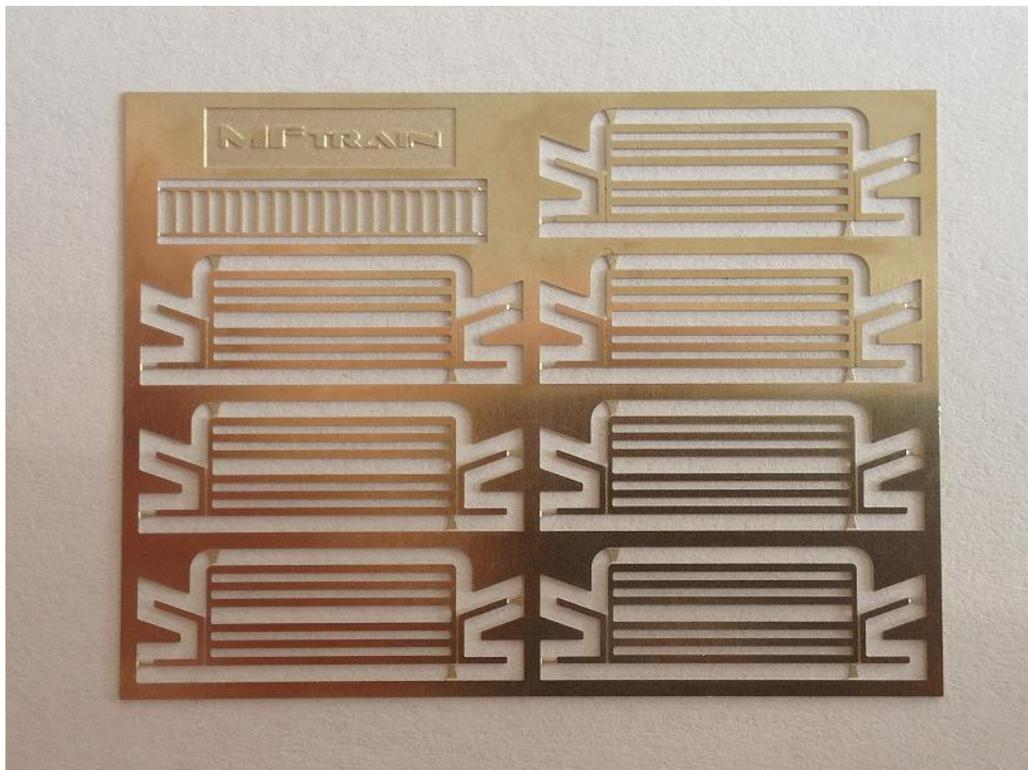
En la siguiente foto podemos observar unas muescas o rebajes realizados en los laterales del banco, las cuales nos ayudarán a doblar los mismos. Tener en cuenta que el rebaje siempre debe quedar por la parte exterior de la pieza una vez doblada.
