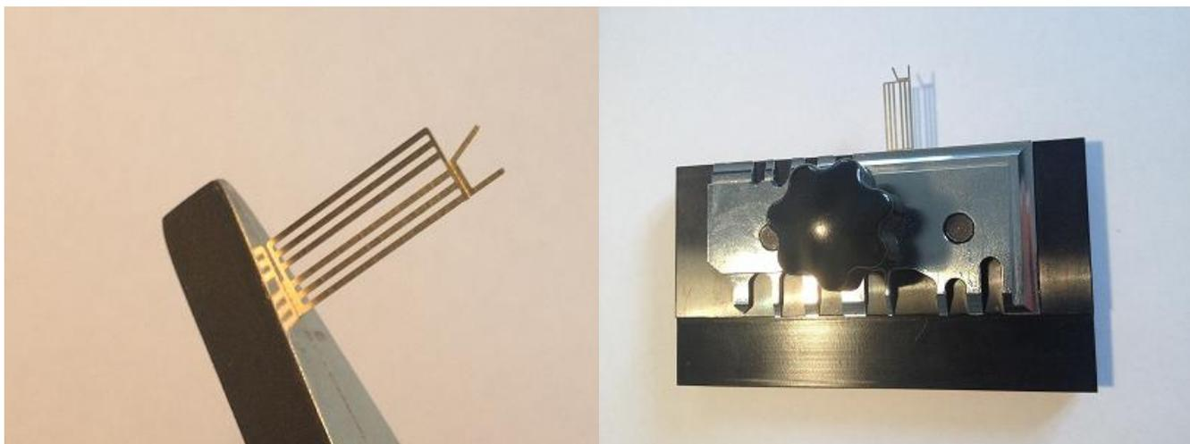
Fijaremos uno de los laterales del banco justo por el rebaje (tal y como se puede observar en cualquiera de las dos fotos anteriores, independientemente de la herramienta utilizada) y con la ayuda de una regla metálica, doblaremos la pieza a 90 grados, tal y como se puede observar en las siguientes fotos.
