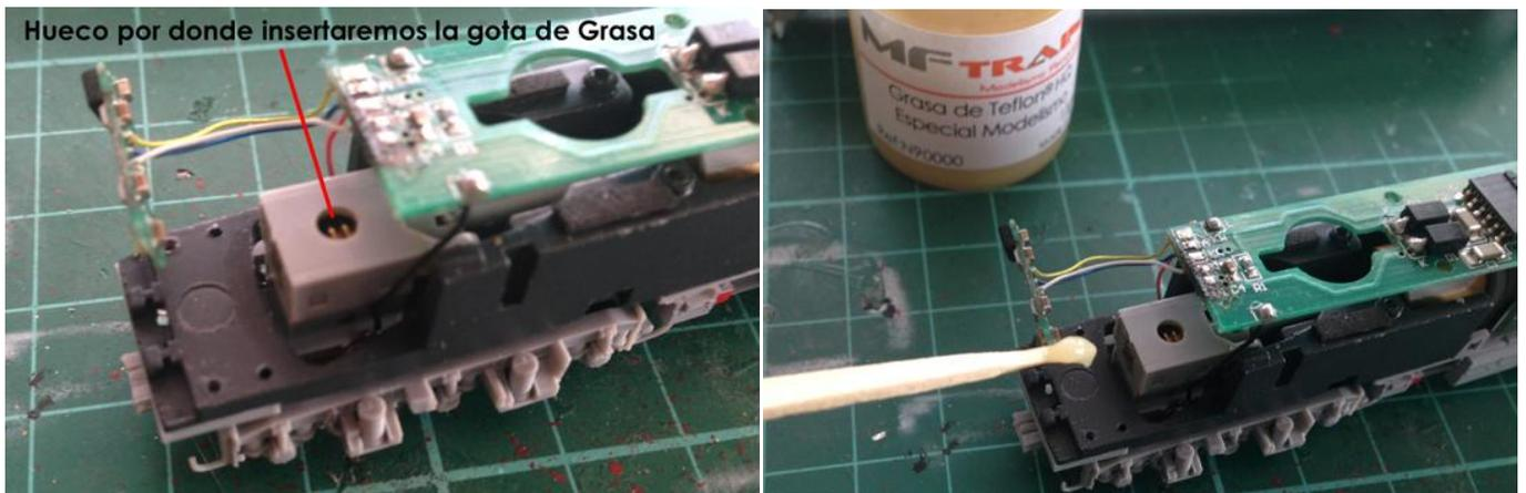
En la foto superior se puede apreciar el pequeño orificio por donde depositaremos una pequeña gota de grasa con la ayuda de un palillo.
