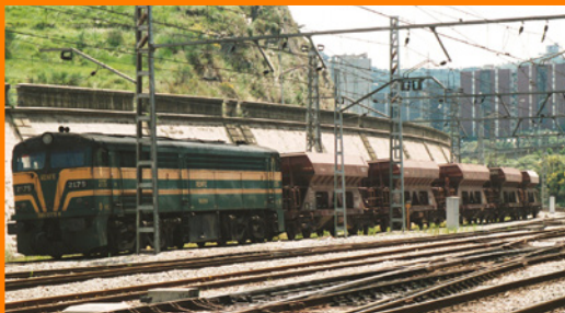
Locomotora ALCO 321-075 con un pequeño corte de tolvas tipo "TTF" destinadas al transporte de balasto para renovación de vía (Montcada-Bifurcació. Foto: Xavier Español)
