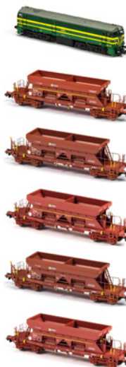
Locomotora ALCO 321-075 con un pequeño corte de tolvas tipo "TTF" destinadas al transporte de balasto para renovación de vía (Montcada-Bifurcació. Foto: Xavier Español)
